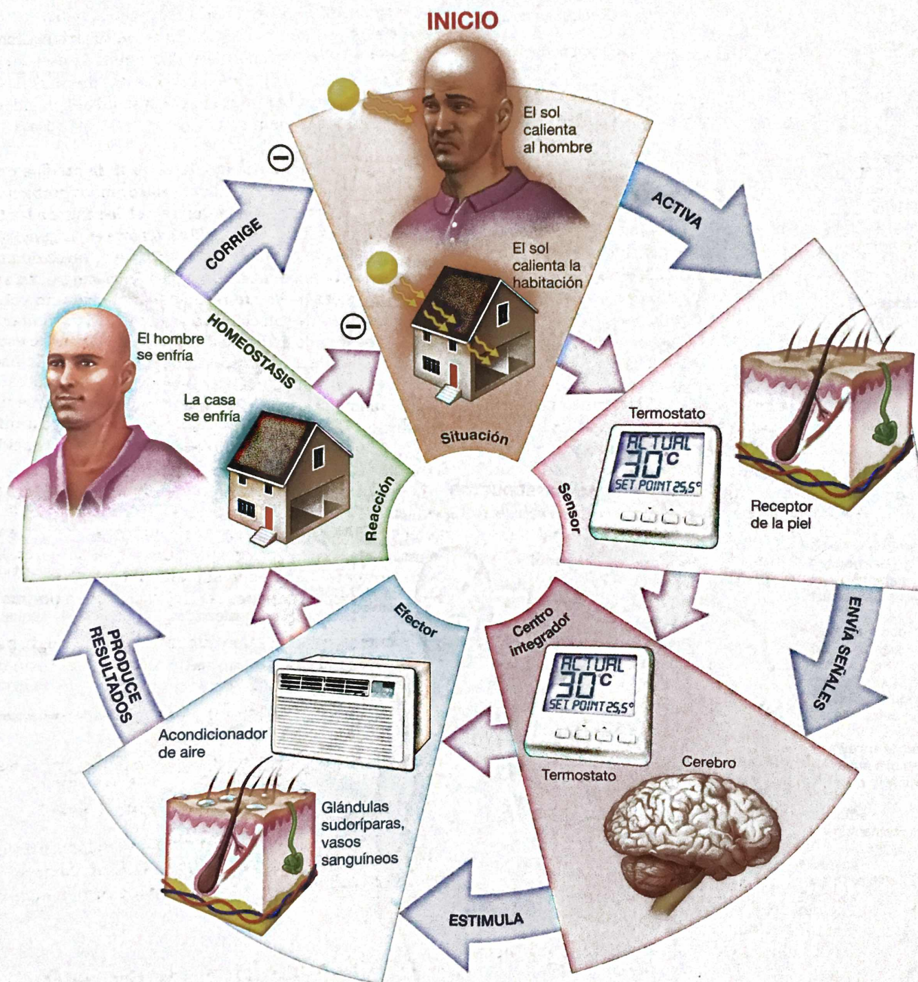
Figura 1-7. La retroalimentación negativa restablece la homeostasis. Se utiliza para mantener la temperatura constante en una habitación (círculo interior) y en una persona (círculo exterior). Indique cuáles son los efectores que responden a cambios en la temperatura corporal.
